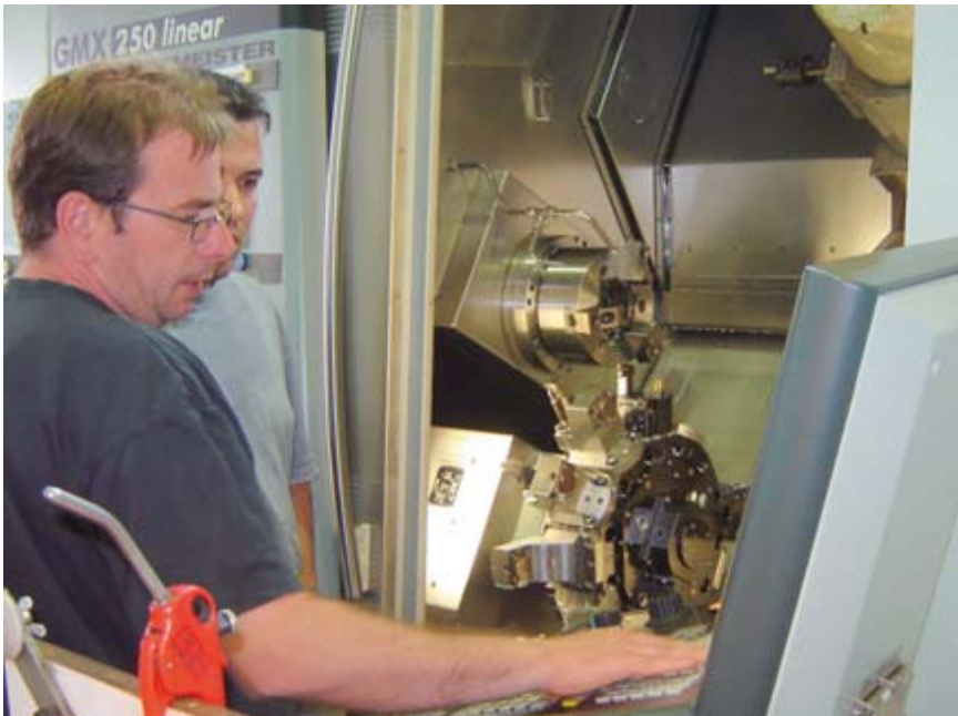
Um die immer komplizierter werdenden Trägerwerkzeuge mit maximaler Präzision bearbeiten zu können, setzt die Firma zwei Drehfräszentren von DMG ein.
