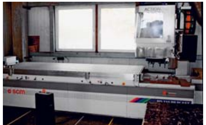
Auf diesem 5-Achs-Bearbeitungszentrum sollen künftig 95 Prozent der Holzkonstruktionen für die Deckaufbauten und den Innenausbau bearbeitet werden
