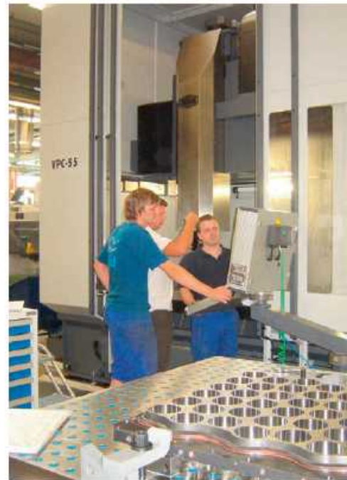
Missler-Vertriebspartner Adequate Solutions implementierte die CAD/CAM-Lösung, bildete den Maschinenpark kinematisch in 3D ab und passte die Postprozessoren für die Maschinen an.
